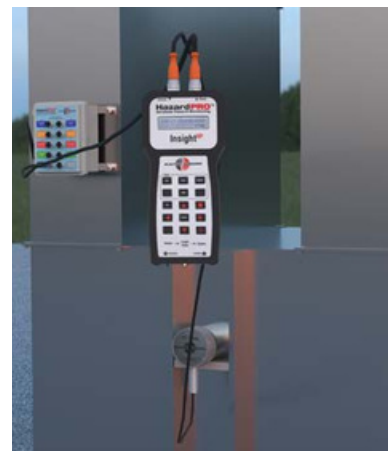
InsightHP conectado a um sensor de velocidade no elevador para testar o funcionamento adequado
