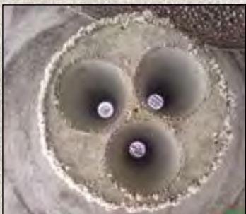
Exterior do sensor está coberto de pó, enquanto as propriedades autolimpantes mantêm os transdutores limpos e funcionais.
